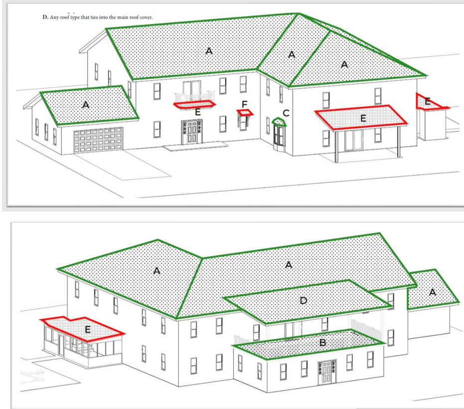
Figura 2.10: Áreas del techo: vivienda de ejemplo, parte trasera
