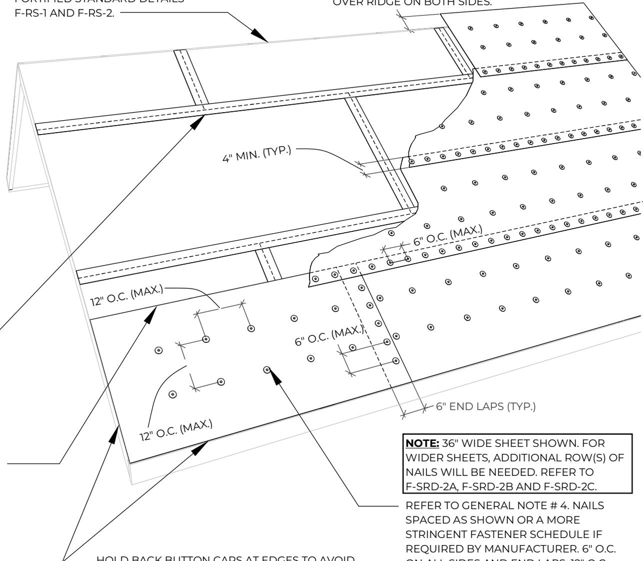
HOLD BACK BUTTON CAPS AT EDGES TO AVOID INSTALLING DRIP EDGE OVER BUTTON CAPS. REFER TO F-DE-1 FOR DRIP EDGE INSTALLATION.
